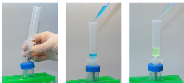
Abb. 3 Beladung mit Schwerkraft a (links), b (Mitte), c (rechts)
